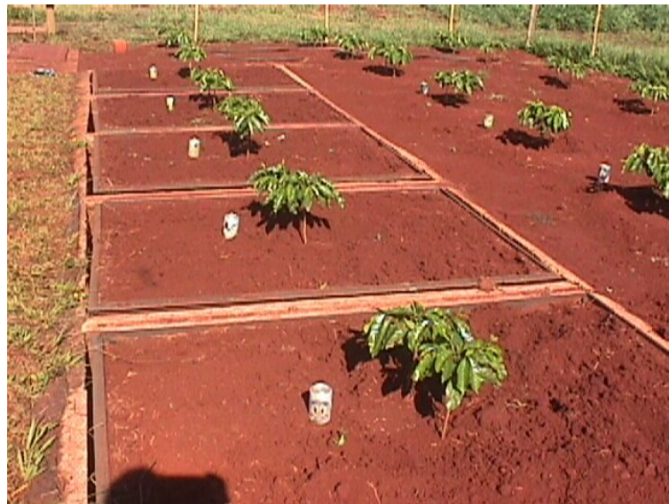
Figura 4. Bateria com cinco lisímetros de pesagem, usando células de carga.
