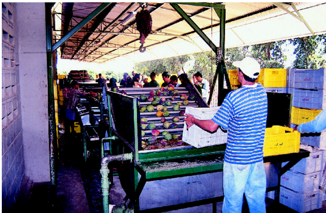
Figura 30. Descarregamento da manga no tanque de recepção e lavagem.
