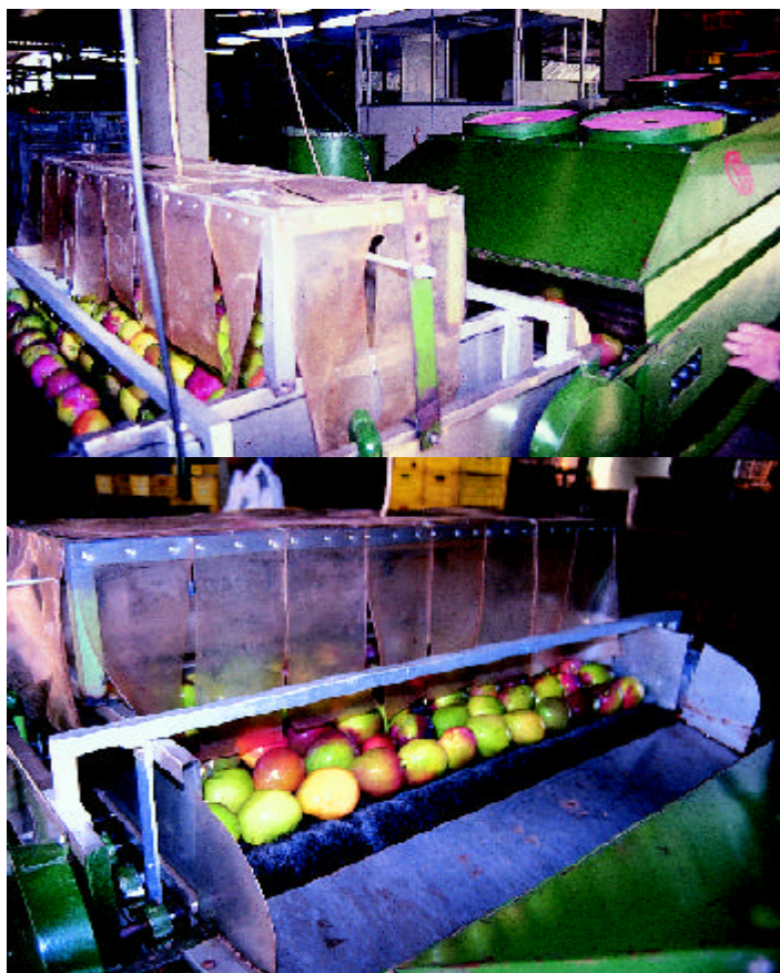
Figura 35. Sistema de aplicação de cera e polimento.
