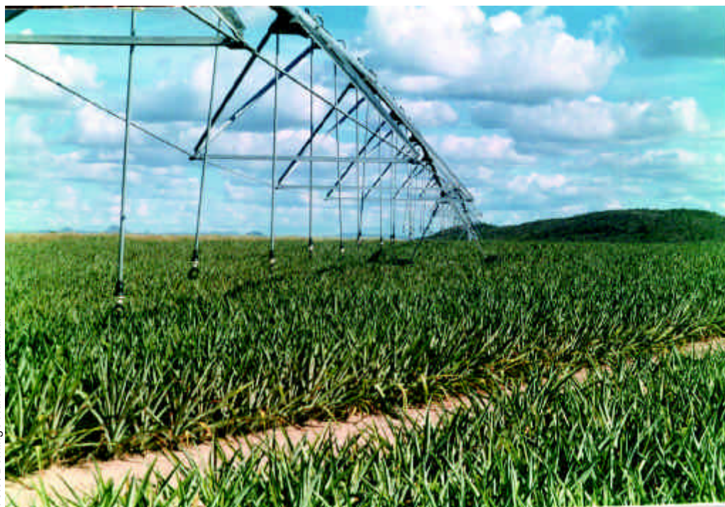
Figura 12. Utilização do sistema de irrigação por pivô central, com rebaixamento das bengalas dos aspersores.
