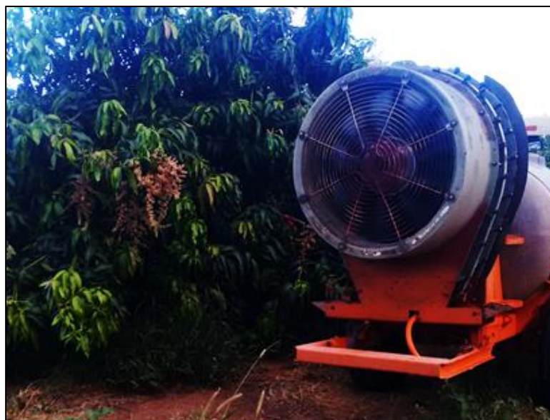
Figura 2. Pulverizador tratorizado Jacto Arbus ® no momento da aplicação dos tratamentos em mangueira cv. Palmer, Petrolina-PE.
