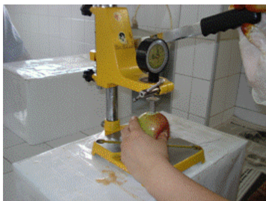
Figura 94 – Penetrômetro utilizado para medir a firmeza da polpa das frutas. Foto: José Carlos Fachinello
